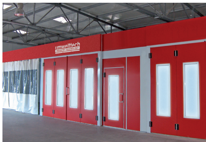
PILOT S400-Kabinen mit Vorbereitungsplätzen
